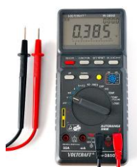
Polímetro. Instrumento de electricista.
